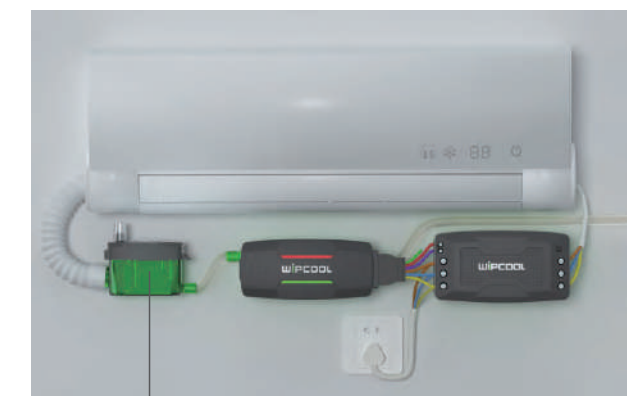
Estado de drenaje de falla: la salida se cortó cuando el agua alcanza el nivel de alarma para activar el interruptor de seguridad, para evitar que el equipo de refrigeración continúe generando agua condensada
